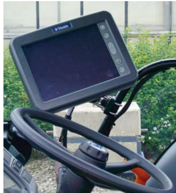
Um mit dem AGRAVIS Net zu arbeiten, muss in den Schlepper oder Selbstfahrer ein Lenkautomat eingebaut werden, der über die Signale des Netzwerkes gesteuert wird.
